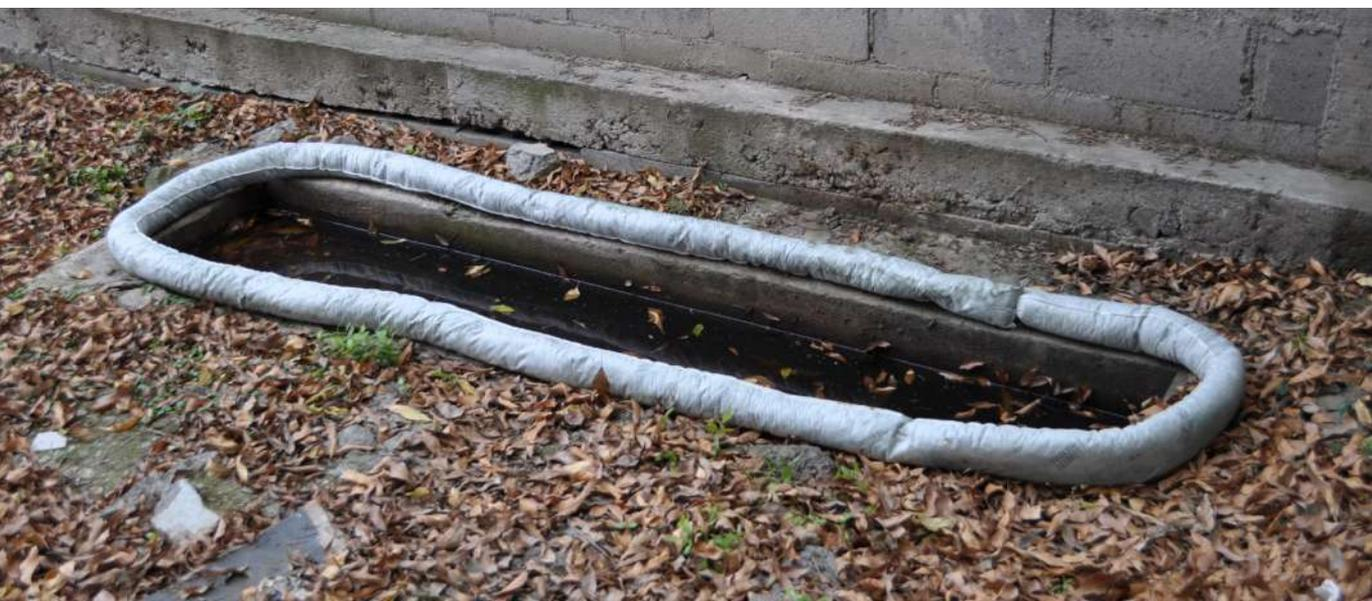
Presentación ideal para usarse como contención en derrames de volúmenes grandes, es la mejor opción para evitar la propagación de derrames en un área específica, especialmente áreas de descarga, áreas de almacenamiento, disposición o de abastecimiento.
