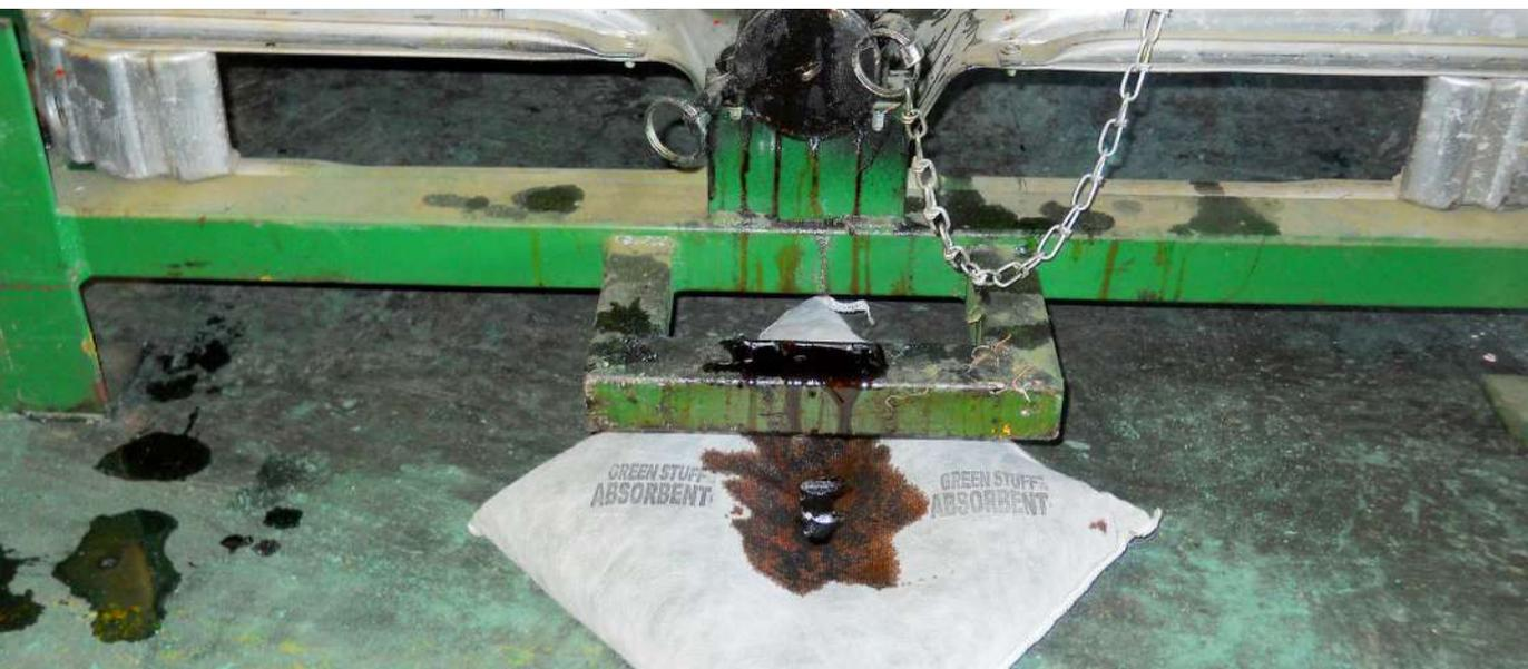
Ideales para sustituir los recipientes que se usan para contener los goteos intermitentes en maquinaria, puede manipularse para hacerse más estrecha y colocarse debajo de áreas difíciles de limpiar, especialmente en áreas de trabajo donde hay derrames constantes de aceite. Puede usarse para absorber derrames de volúmenes pequeños a medianos que requieren una respuesta inmediata.
