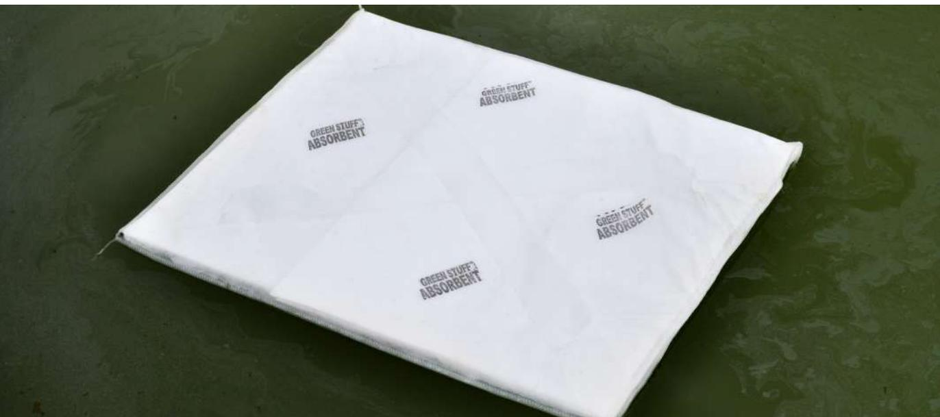
Tapete de polipropileno hidrofóbico para absorber aceites, cuenta con un aditamento especial para recogerlo fácilmente una vez saturado. Su cubierta de polipropileno lo hace más confiable ya que permite la absorción del líquido, pero no su lixiviación garantizando la correcta contención de su derrame.
